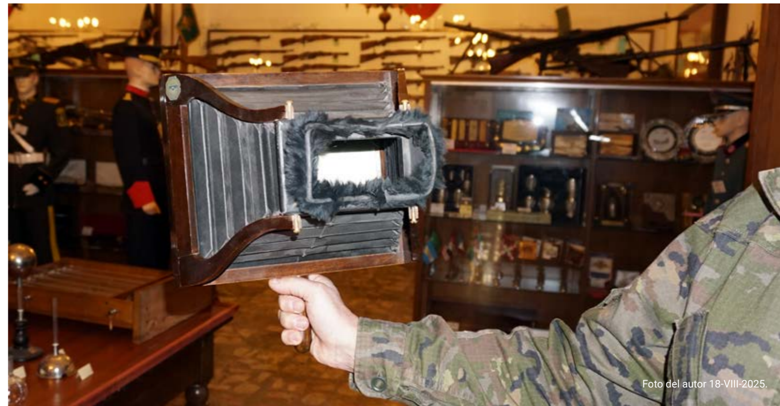
Visor para radioscopias del aparato de Rx. de Mónico Sánchez. Museo de la Academia General Militar.
