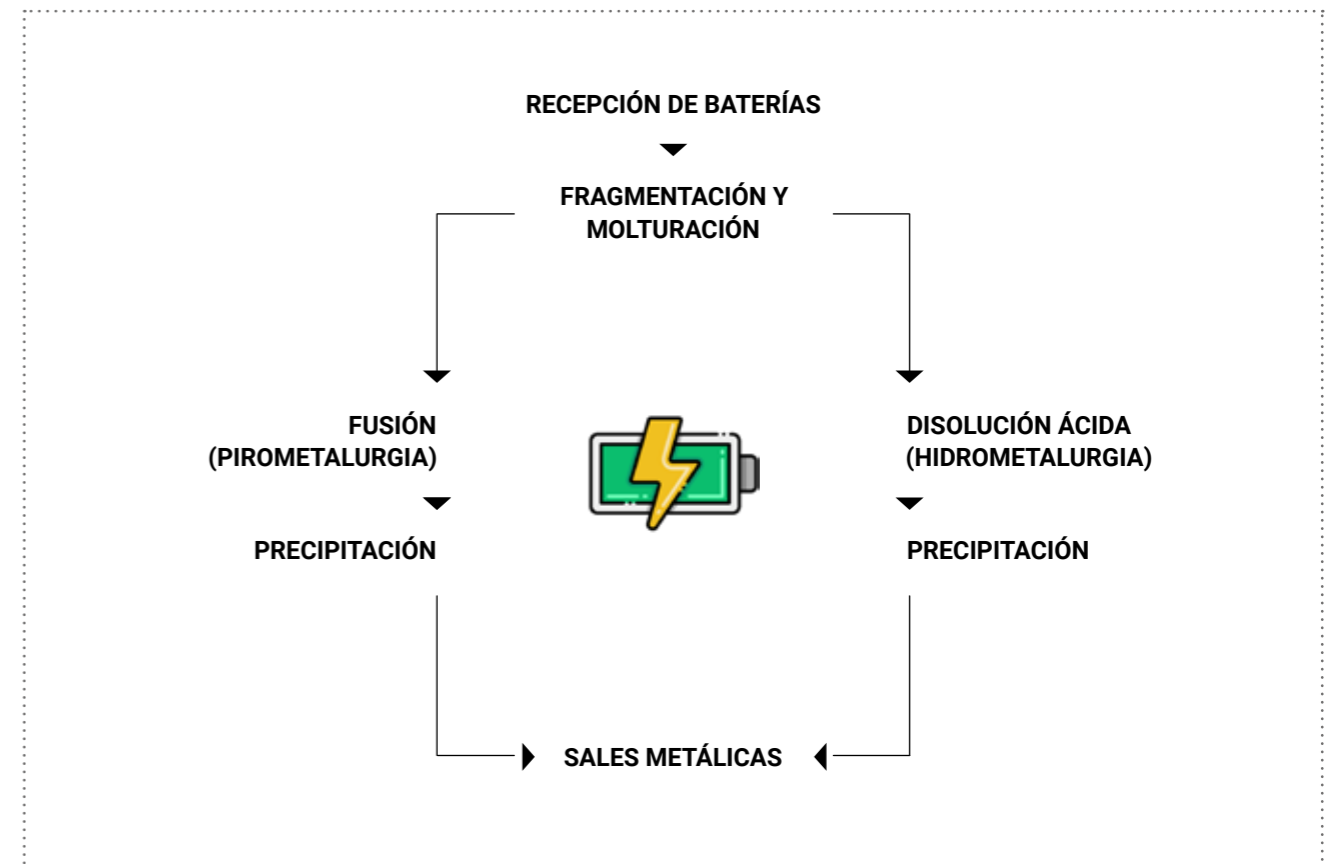
Figura 6: proceso de reciclado de baterías de Li.
