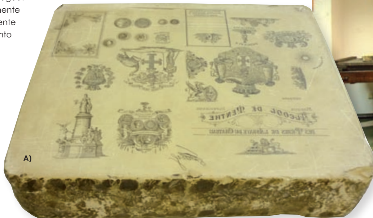
A) Piedra litográfica con dibujos de marcas y etiquetas. B) Piedras litográficas. C) Prensa litográfica tipo Brisset (alrededor de 1900).
