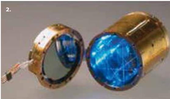
**1)** Cristal de 10,7 kg de NaI utilizado en uno de los prototipos del experimento ANAIS.
