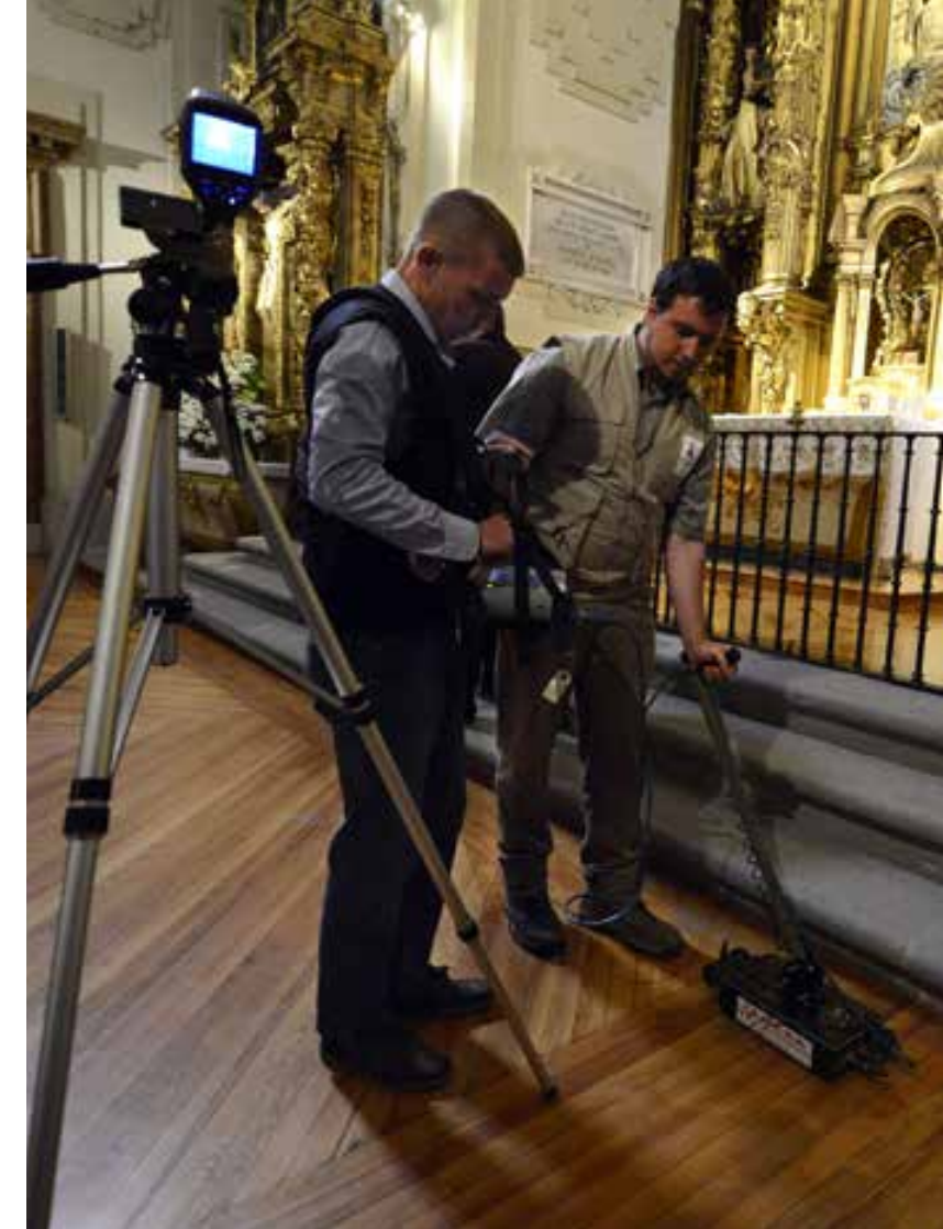
Toma de datos mediante georadar 5.
