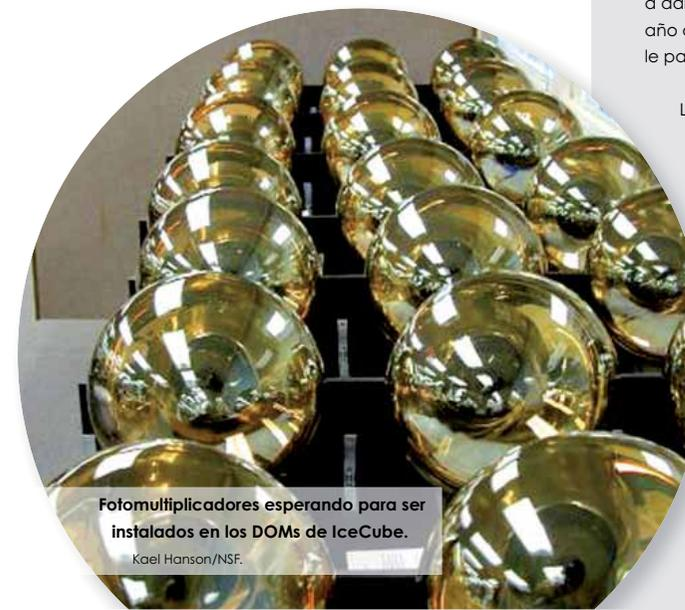
Fotomultiplicadores esperando para ser instalados en los DOMs de IceCube.
