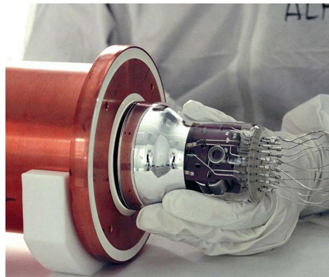
◀ **Detalle de uno de los módulos de ANAIS en el proceso de acoplamiento al fotomultiplicador de alta eficiencia cuántica en la sala limpia del Laboratorio Subterráneo de Canfranc.**
