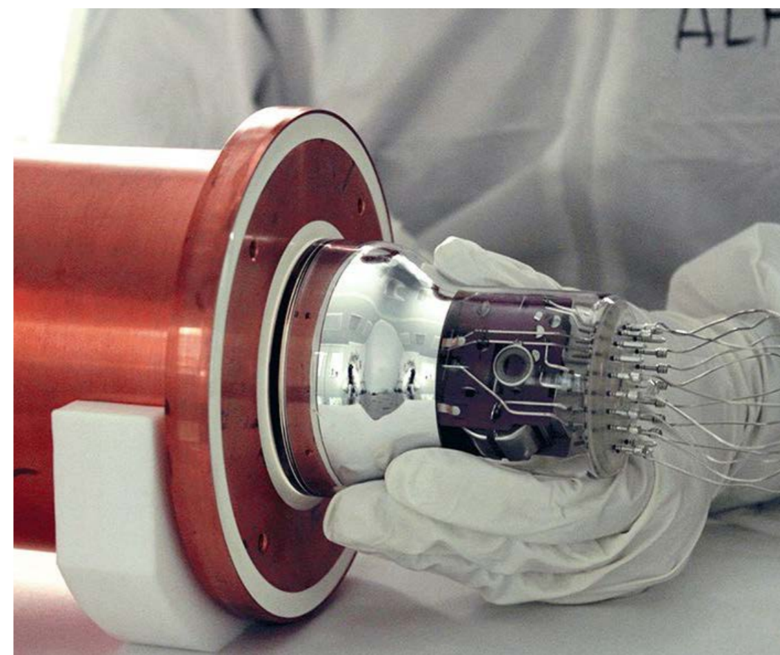
◀ Detalle de uno de los módulos de ANAIS en el proceso de acoplamiento al fotomultiplicador de alta eficiencia cuántica en la sala limpia del Laboratorio Subterráneo de Canfranc.
